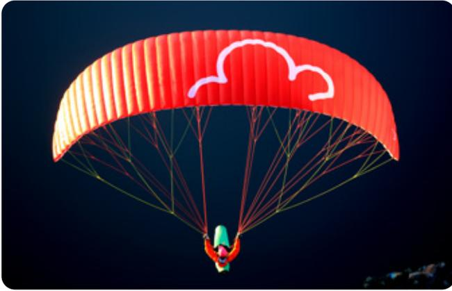
Niveau Feeling, la commande de frein gagne en homogénéité, devient plus linéaire et gagne encore en débattement avec presque 70cm avant le point de décrochage et un effort rédhitoire sur les 10 dernier cm.
